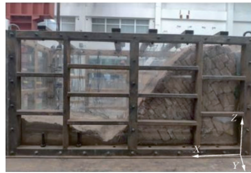
图4 搭建完成的边坡模型
